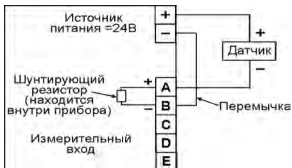
Рис.2.6 Схема включения датчика с выходным сигналом тока (4-20) мА и питанием от прибора
